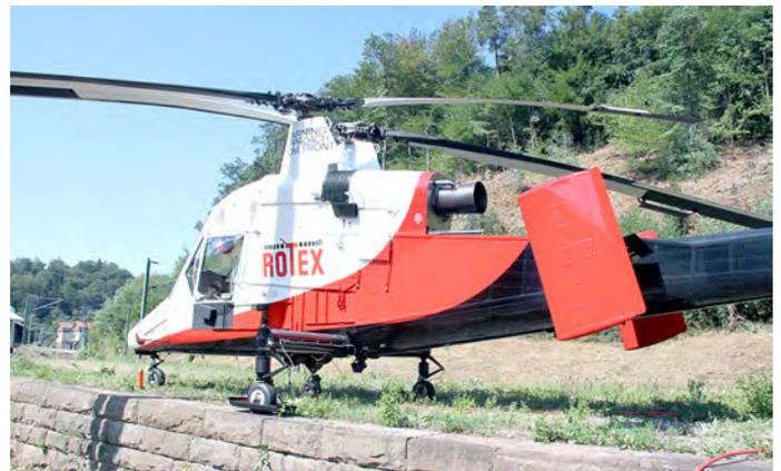
Der Helikopter K-1200 K-Max, der bei den Baumfällarbeiten in Neuenbürg zum Einsatz kam, wurde speziell für den Transport von Außenlasten entwickelt.
