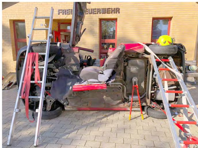
2 Steckleiterteile sicherten das auf der Seite liegende Fahrzeug gegen Umkippen. Im Anschluss wurde der Fahrersitz samt Unterboden „herausgeklappt“.
